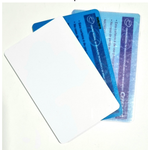
Figura 5 – tags RFID em formato de cartão para simular os equipamentos hospitalares.
